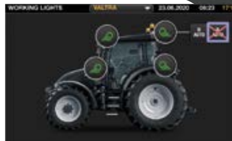
Die Arbeitsleuchten lassen sich ganz einfach über den 9-Zoll-Touchscreen konfigurieren. Außerdem gibt es Ein-/Aus-Tasten für die Arbeitsleuchten und die Rundumleuchte in der Armlehne.
