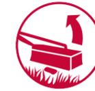
Die patentierte Anfahrsicherung SafetySwing sorgt für optimale Sicherheit auf jedem Feld und schützt Ihre Maschine zuverlässig vor Schäden durch angefahrene Gegenstände. Das Mähwerk klappt bei einem Hindernis nach hinten oben weg – und klinkt sich anschließend durch Eigengewicht wieder in die Arbeitsposition ein.
