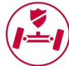
FELLA bietet als einziger Hersteller am Markt eine Lenkung für den Schwader an, die innerhalb des Rahmens verläuft. Die Lenkwelle ist durch den Rahmen gegen Beschädigungen geschützt und hat im Gegensatz zu außen liegenden Lenkstangen nur zwei Umlenkpunkte. Dadurch ist auch nach Jahren ein exaktes Lenkverhalten gegeben und Ihre Sicherheit gewährleistet.
