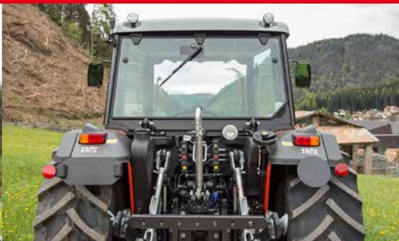
Das Kraftpaket überzeugt durch einen extrem niedrigen Schwerpunkt und einer geringen Durchfahrhöhe von lediglich 2,30 m. Aufgrund seiner kompakten Abmessungen und dem niedrigen Leistungsgewicht ist er prädestiniert für Arbeiten am Hang. Auch Viehbetriebe mit engen Einfahrten profitieren von seinem Exterieur.
