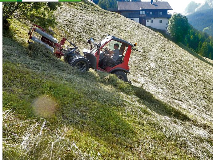
L'applicazione frontale del mod. 90 permette di realizzare l'andana senza calpestare il foraggio, garantisce all'operatore un'ottima visibilità e gli permette di mantenere sul trattore una posizione perfettamente ergonomica. Per questi motivi il ranghinatoro Mod. 90 è particolarmente indicato, oltre che per la raccolta dell'erba medica, anche nelle cure di raccolta delle lenticchie.
