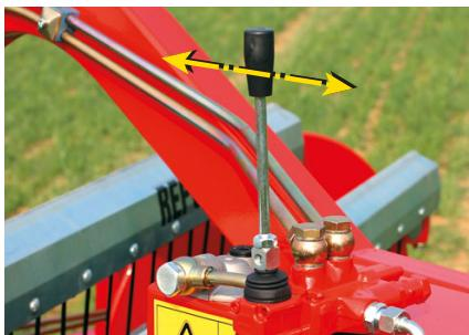
Gli aspi sono azionati idraulicamente (da un impianto indipendente dal trattore) e ruotano ad una velocità ottimale, costante e non vincolata a quella di avanzamento. Questo permette di scegliere la velocità di lavoro più adatta in base al tipo di prodotto da ranghinare. In caso di urti accidentali gli aspi si bloccano grazie ad una valvola di sicurezza opportunamente tarata.
