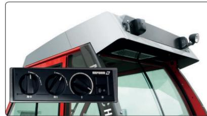
Optimales Arbeitsklima mit der in das Dach integrierten **Klimaanlage** (Serie bei H7 X / H9 X) od. zusätzliche Frischluftzufuhr, bei geschlossener Kabine, über die integrierte **Dachbelüftungsanlage** (nicht bei G7 RX / H7 RX / H7 X / H9 X).
