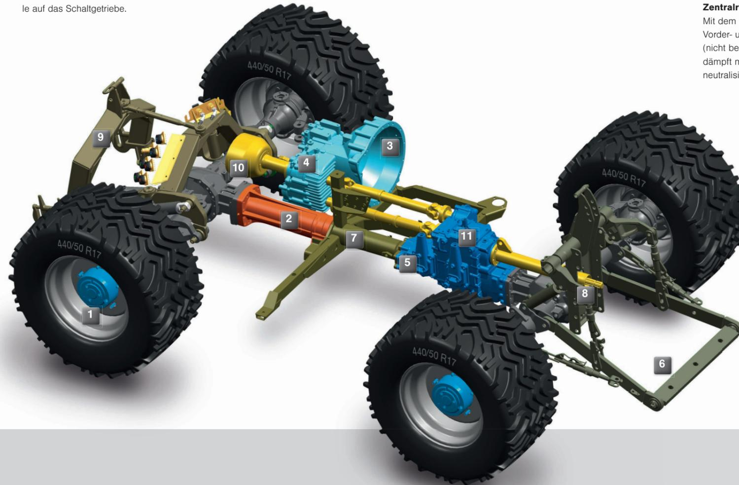
**8** Die **Heckzapfwellen** ist elektrohydraulisch schaltbar und gewährleistet dank der automatischen Anlaufsteuerung ein sanftes Anlaufen von Arbeitsgeräten (gilt nicht für G3 / G3 X: Getriebezapfwellen hinten).
