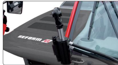
Mit dem **hydraulischen Oberlenker** können Sie rasch von der Kabine aus auf Bodenunebenheiten reagieren oder bequem auf Knopfdruck die Schnitthöhe verstellen.
