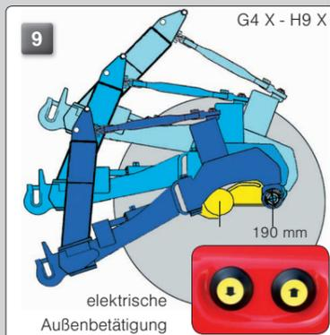
Das starke, achsgeführte **Fronthubwerk (9)** gewährleistet beste Boden Anpassung durch weit hinter der Vorderachse liegende Drehpunkte. Die serienmäßige hydraulische (G3 / G3 X) oder elektro-hydraulische Geräteentlastung sorgt für höhere Traktion sowie bessere Steigfähigkeit bei gleichzeitig bester Boden Anpassung und -schonung. Seitenverschub: Noch größere Hangtauglichkeit durch Schwerpunktverlagerung. Ermöglicht das nahe Arbeiten an Hindernissen und erleichtert den Geräteanbau.
