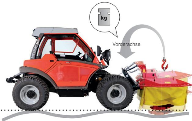
Das Mähwerk folgt den Bodenkonturen ohne Veränderung des Entlastungsdruckes.
