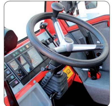
Die **neigungseinstellbare Lenksäule** gewährleistet eine optimale Sitzposition.
