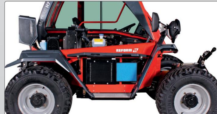
Beim H7 RX werden **Servicefreundlichkeit** und optimale Zugänglichkeit der Komponenten großgeschrieben. So sind sämtliche Service- und Wartungskappen einfach und werkzeuglos zu öffnen. Dies erleichtert insbesondere die täglichen Servicearbeiten wie die Kontrolle und Servicing von Scheibenwaschwasser, Luftfilter, Motorölstand, Bremsflüssigkeitsbehälter, Kupplungsflüssigkeit, uva.
