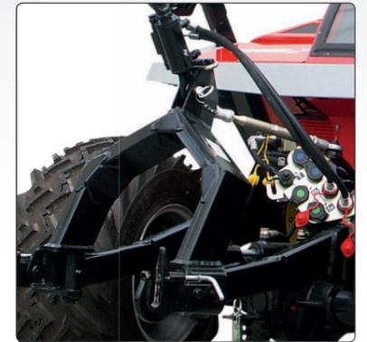
Der Metrac H4 X verfügt serienmäßig über ein **Fronthubwerk** mit integriertem Seitenverschub.
