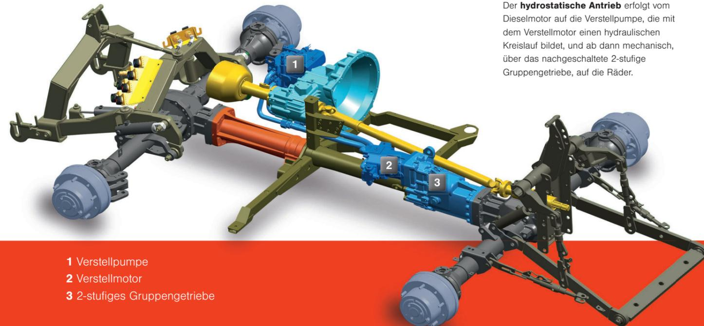
Der **hydrostatische Antrieb** erfolgt vom Dieselmotor auf die Verstellpumpe, die mit dem Verstellmotor einen hydraulischen Kreislauf bildet, und ab dann mechanisch, über das nachgeschaltete 2-stufige Gruppengetriebe, auf die Räder.
