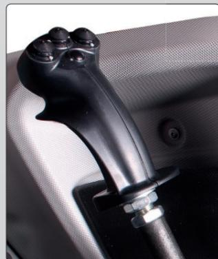
Der **neue Multifunktionshebel** erleichtert die Bedienung und garantiert sicheres und effizientes Arbeiten in allen Lagen. Es ist nun möglich, die zentralen Bedienfunktionen, wie Front- und Heckhubwerk, einfach und präzise mit einer Hand zu bedienen. Sämtliche Bedienelemente sind ergonomisch und übersichtlich in Funktionsgruppen angeordnet und liegen im Griffbereich des Fahrers - so hat dieser stets alles sicher im Griff und kann sich voll auf den Arbeitseinsatz konzentrieren.
