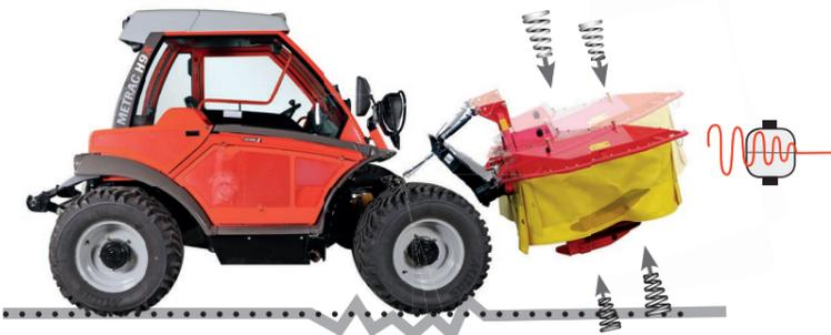
Die Stoßbelastungen werden durch Gasdruckspeicher minimiert.
