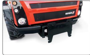
Mit der **Geräteanbauplatte** können Frontgeräte auch direkt angebaut werden z. B. Schneepflug oder -fräse.
