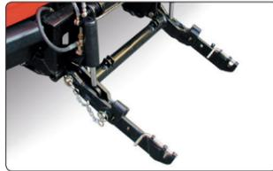
Das **hydr. 3-Punkt-Fronthubwerk** (am Frontanbaurahmen montiert) ist mit hydr. Geräteentlastung erhältlich.
