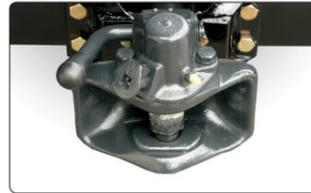
Automatische **Anhängekupplung** gibt es in drehbarer Ausführung hinten.
