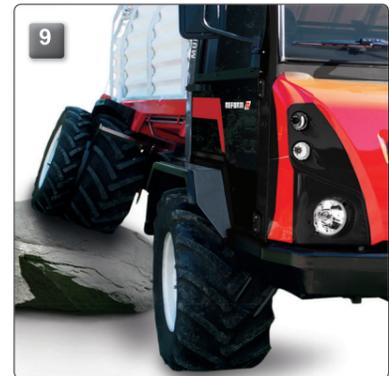
Zwischen Vorder- und Hinterachse sorgt das **drehbare Zentralgelenk (9)** für ständige Bodenhaftung aller 4 Räder und gewährleistet sicheres Fahrverhalten in jeder Situation. Sie haben volle Kraftübertragung und optimale Bodenschonung auch im unwegsamen Gelände.
