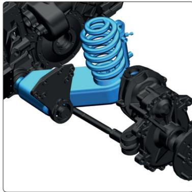
Der Federungskomfort über Schraubenfedern mit elastischen Anschlagpuffern beruht auf einem ausgewogen abgestimmten Fahrwerk mit **Einzelradaufhängung** an **Längslenkern** vorne. Hydraulik-Zylinder und Hydro-Speicher mit der Funktion von Stoßdämpfern unterstützen den Federungskomfort.
