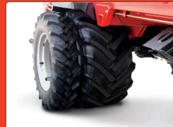
Es gibt ein großes Angebot an **Bereifungsvarianten** für vorne und/oder hinten. Der An- und Abbau der Zusatzbereifungen erfolgt rasch und problemlos dank Schnellverschluss.
