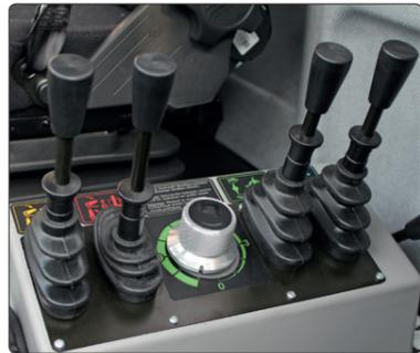
Die Betätigung der **Hydraulik** mittels mechanischen Steuergeräten wird beim Muli T7 S sehr geschätzt. Sie ist griffgünstig, seitlich neben dem Sitz angeordnet und gewährleistet eine ergonomische Bedienung.
