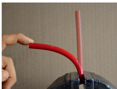
*Die Kunststoffzinken bestehen aus elastischem und extrem widerstandsfähigem Material. Der Verschleiss ist gering, die Standzeiten sind dementsprechend hoch.*
