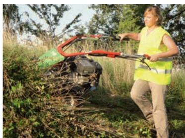
Der Rapid Swiss ist ein leichter, kompakter und speziell wendiger Einachsgeräteträger. Der stufenlose hydrostatische Antrieb und die über den Holm gesteuerte Aktivlenkung sorgen auch in schwierigsten Einsatzgebieten für einfache Manövrierbarkeit. Der tiefe Schwerpunkt sowie die Vielfalt der Bereifungsmöglichkeiten machen den Rapid Swiss bis in sehr steile Lagen zum effizienten und sicheren Arbeitsgerät.
