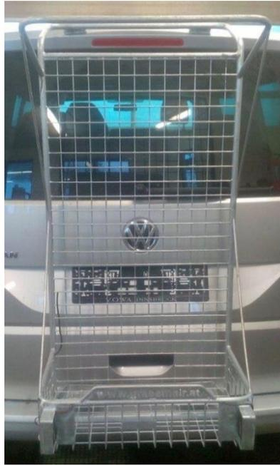
Heckklappe mittig montiert
